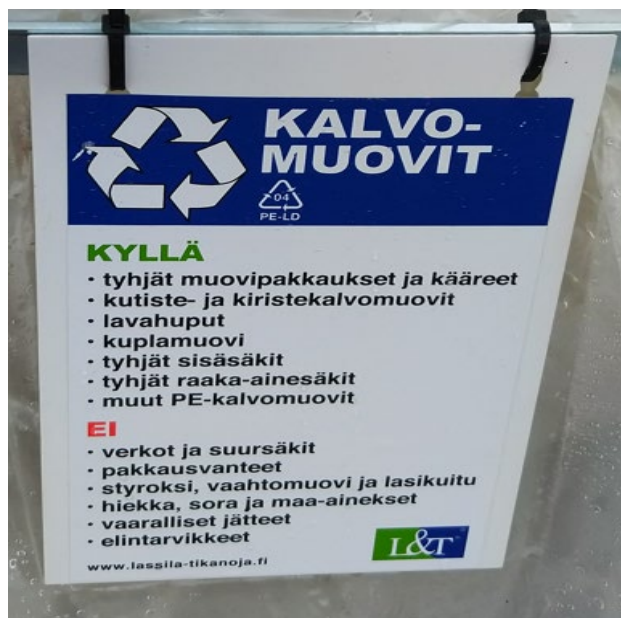
Kuva 1. Ohjeet kalvomuovin erilliskeräykseen työmaalla.
